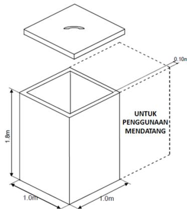
Gambar 2. Sketsa fasilitas penguburan Limbah benda tajam dengan dimensi berukuran 1,8 m x 1m x 1m (satu koma delapan meter kali satu meter kali satu meter).
