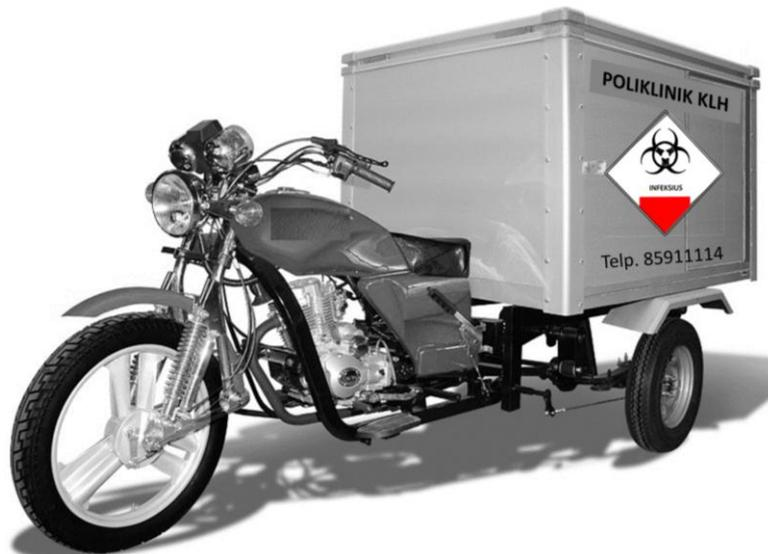
Gambar 9. Contoh pemberian simbol pada alat angkut roda tiga.
